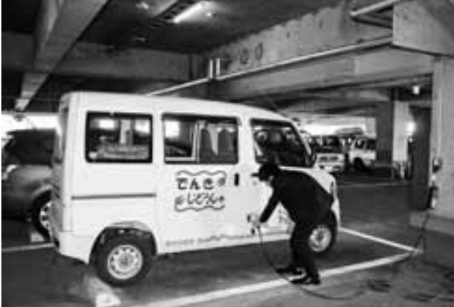
温暖化防止対策として注目されている電気自動車の普及のため、市役所駐車場に急速充電器が設置される予定である（写真は市役所3階駐車場の普通充電器）
