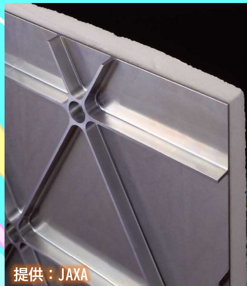
H-IIA ロケットタンク断面
