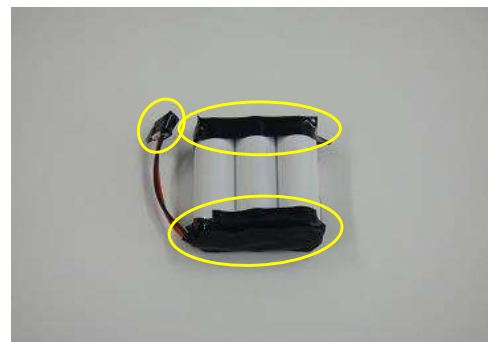
(電池端子・端子連結部被覆／電池固定)
