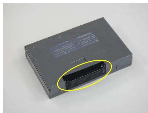
(電極端子部の被覆)
