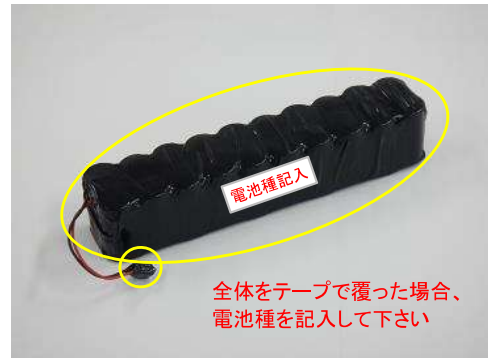
(チューブケースの被覆固定／コネクター部被覆)
