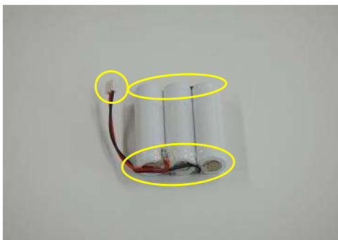
(電池端子・端子連結部露出)
