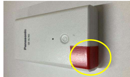
(モバイルバッテリーの端子部の被覆)
