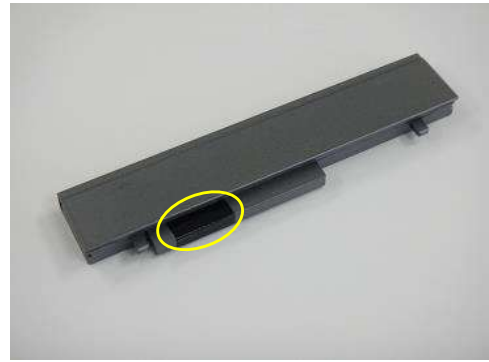
(電極端子部の被覆)
