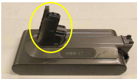
(クリーナー用電池の端子部露出)
