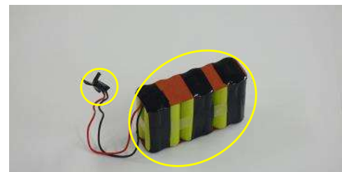
(電池端子連結部当て板の固定 ／コネクター部の被覆)
