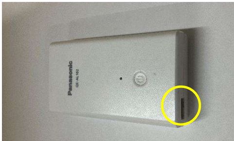
(モバイルバッテリーの端子部露出)
