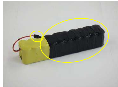
(チューブケースの被覆固定／コネクター部被覆)
