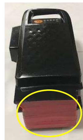
(アシスト自転車用電池の端子部を絶縁)
