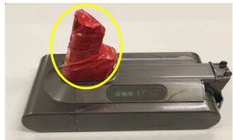
(クリーナー用電池の端子部の被覆)
