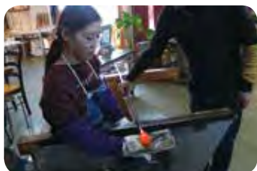
▲水で濡らした新聞紙をあててガラスの形を整えます。熱そうに見えますが全然熱くないです！
