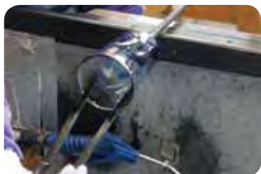
▲ハシ(2回目の登場)を使ってコップの口を広げていきます。
