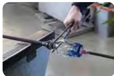
▲竿から竿へコップを移します。意外と簡単に切り離すことができて見ていて爽快でした！
